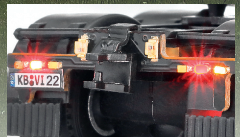
Rück-/Brems-/Blinklichter und Rückfahrcheinwerfer, Infrarot-Sender
